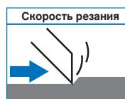
Скорость резания – это скорость, с которой реж. кромка инстр. производит врезание в обр. материал и произв. стружка. Скорость резания V измеряется в метрах в минуту [м/мин] или в метрах в секунду [м/с]. Она зависит от количества оборотов привода n в минуту [об/мин] и диаметра инструмента d  $\times$   $\pi$  (3,14).
