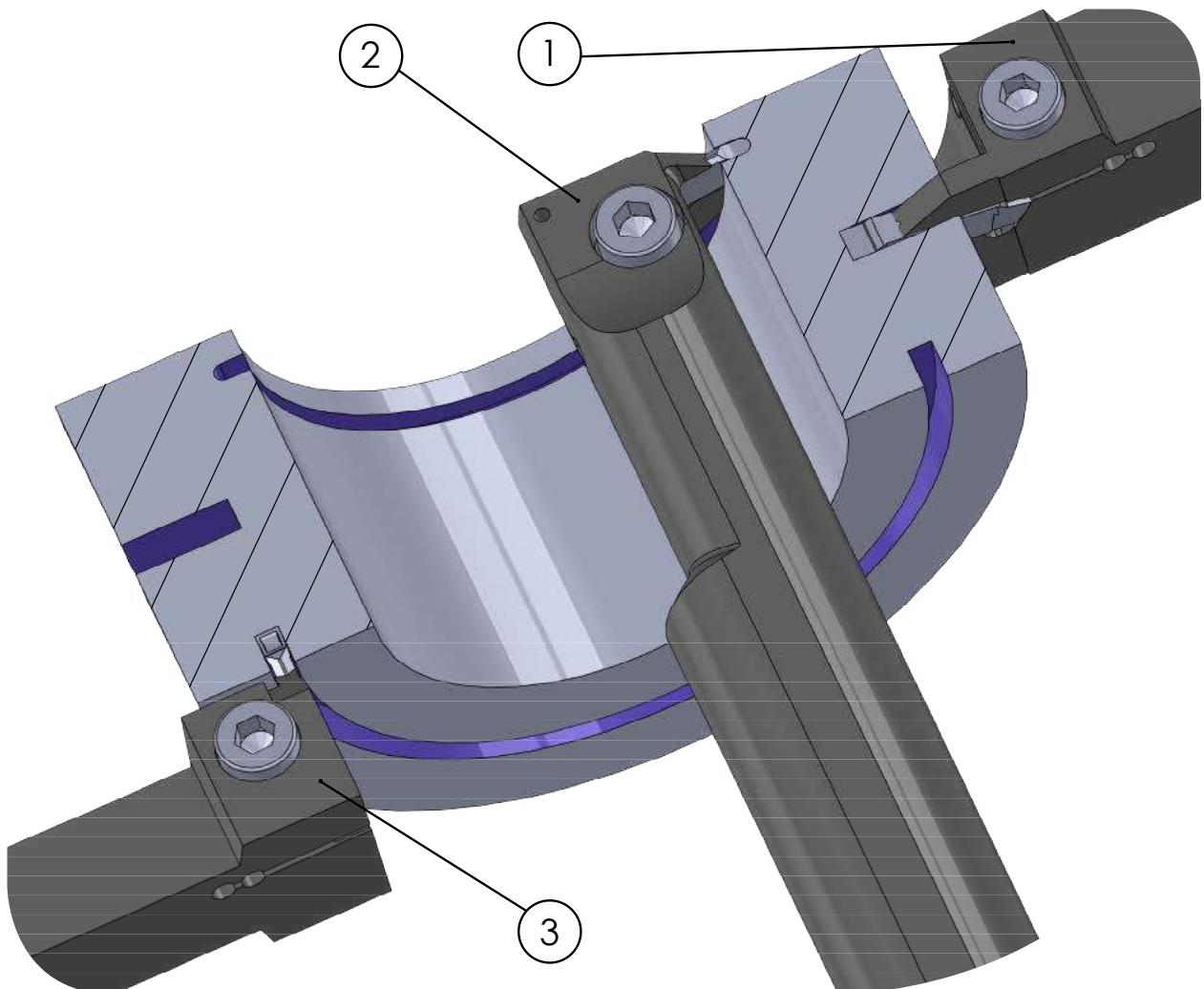
**ТОЧЕНИЕ НАРУЖНОЙ КАНАВКИ. ГЛУБИНА Т MAX. ≤12 ММ., ШИРИНА S = 2.0 - 10.0 ММ**
