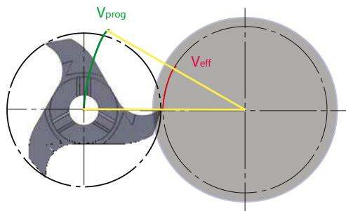
Фрезерование внутреннего контура
