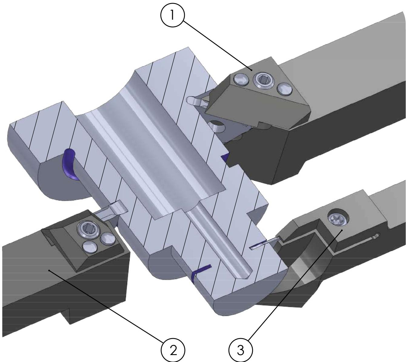
**ТОЧЕНИЕ НАРУЖНОЙ КАНАВКИ. ГЛУБИНА Т MAX. ≤6 ММ., ШИРИНА S = 0.5 - 6.3 ММ**
