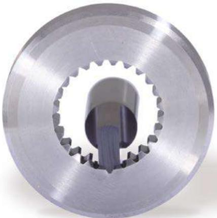
**ОБРАБОТКА ПАЗОВ ОТ Ø 6 / 10 ММ. DIN 138 И DIN 6885**
