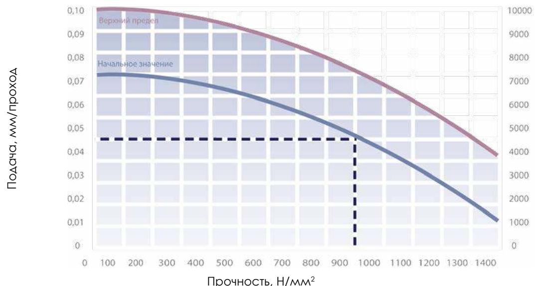
Пример определения режимов резания для Стали 45:
